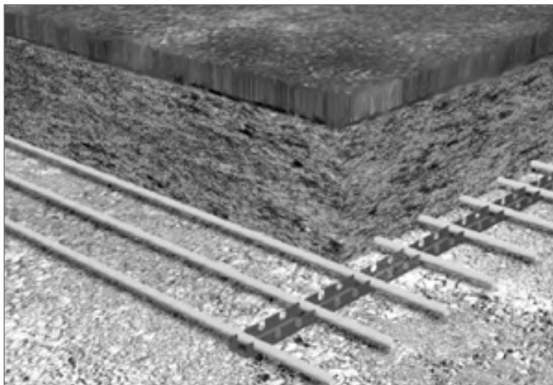
Рис. 2. Подогрев поверхности стадиона с травяным покрытием.
